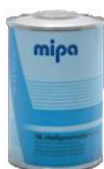
Mipa 1K-Haftpromoter Farblos transparenter Spezial- Haftvermittler für viele Kunststoffuntergründe. Auch auf problematischen Untergründen wie Aluminium eloxiert oder Kupfer ohne Anschleifen verwendbar. Keine Verfärbung eines nachfolgenden Klarlacks durch farblose Einstellung. Spritzfertig.
